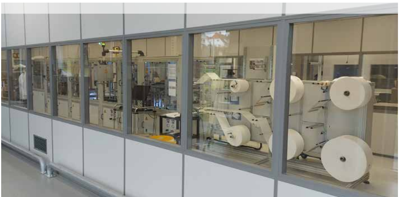
Einhausung und Produktionsmaschine mit den einzelnen Modulen
