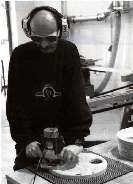
Bearbeiten von Sitzplatten für Schemel – funktional und modern ausgestattete Schreinerei
